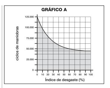
Ejemplo de cálculo de duración de un motorreductor Wingo WG5024 (consulte la Tabla 2 y el Gráfico A):
