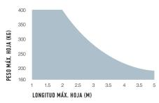
La forma, la altura de la puerta y la presencia de viento fuerte pueden disminuir notablemente los valores indicados en el gráfico. Para las zonas con viento fuerte, son preferibles los modelos 230 Vca.
