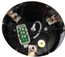
LED lighting system with new IP67 connections and resinated circuit with box Système d'éclairage LED à un degré de protection IP 67, connecteurs IP 67 et circuit résiné dans boîte
